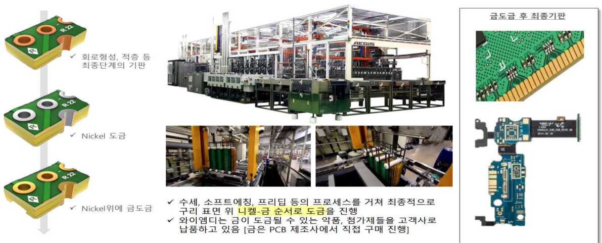
[그림 7] 동사의 최종표면처리제 Soft ENIG의 작용 개념도 및 기관가공 설비
