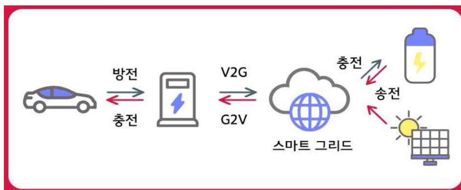
[그림5] 전기차와 에너지 전력망간 연결(V2G)
