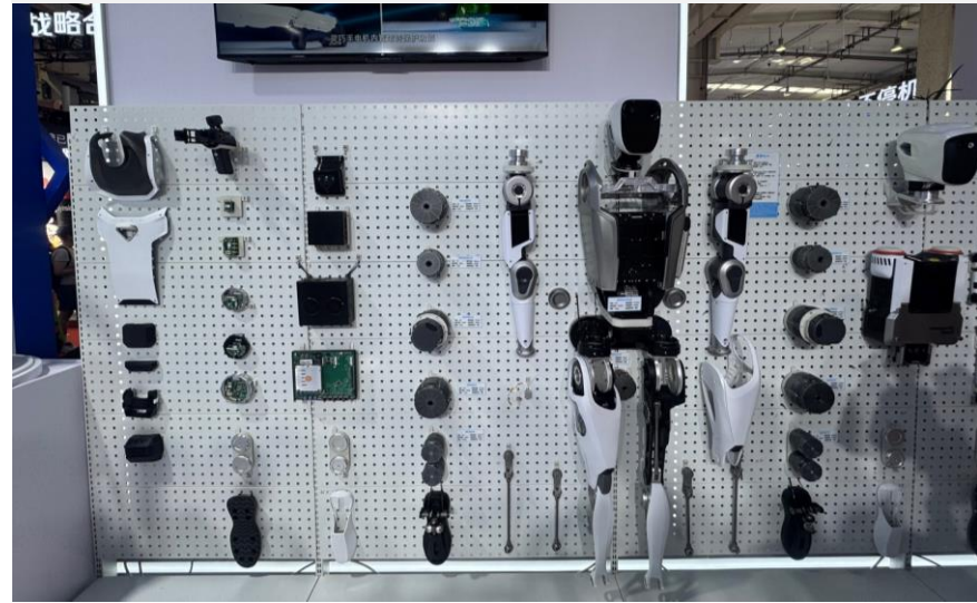
<그림41> 휴머노이드 Break Down: 필요 부품에 있어 표준화 거의 완성
