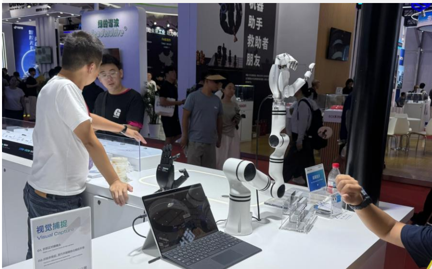
<그림36> 모션 캡처 방식으로 덱스트러스를 제어
