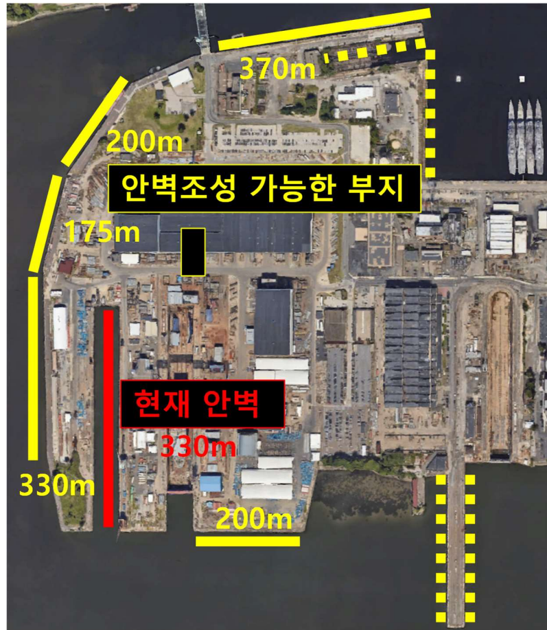
그림8. 필리 조선소의 안벽으로 조성 가능한 부지 추정: 모두 활용 시 MR탱커급 5척 이상 계류 가능할 것
