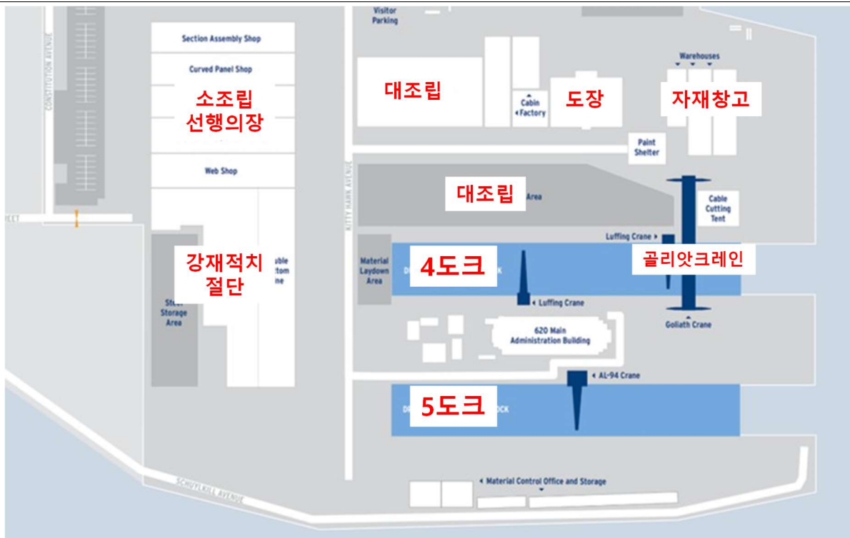
그림6. 필리 조선소 레이아웃: 5도크는 현재 안벽으로 사용 중, 향후 재가동 계획
