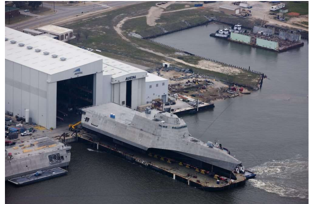
그림45. Austal 미국 조선소: LCS Independence급 실내 건조
