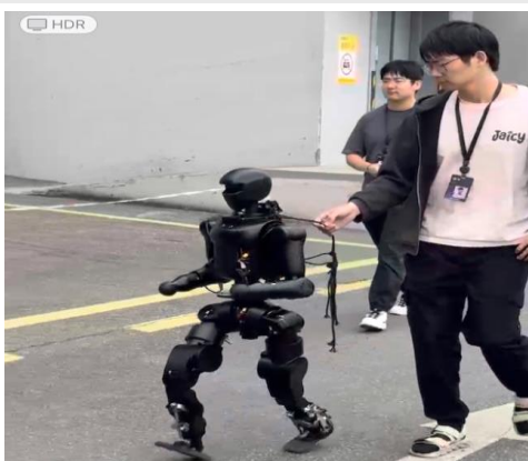
그림7 Fourier 휴머노이드 로봇의 걷기 테스트 중
