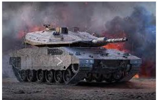
그림4. 이스라엘의 Merkava 전차: 포탑 면적을 최소화하고 전면에 큰 경사각을 주어 피탄 면적을 줄이고, 두꺼운 장갑 채택
