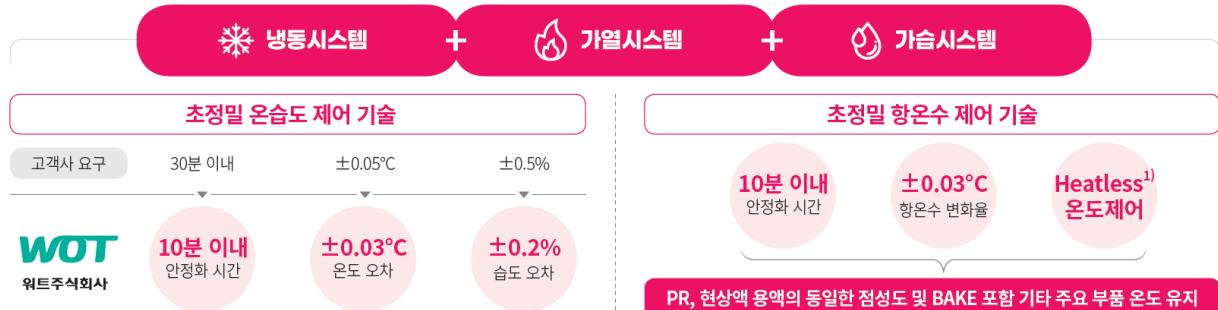
※ 1) Heatless<sup>1)</sup> 장비내에 히터를 제거하고 THC 냉동시스템에서 불가피하게 발생되는 폐열만을 이용하여 온도제어 가열시스템을 적용한 기술
