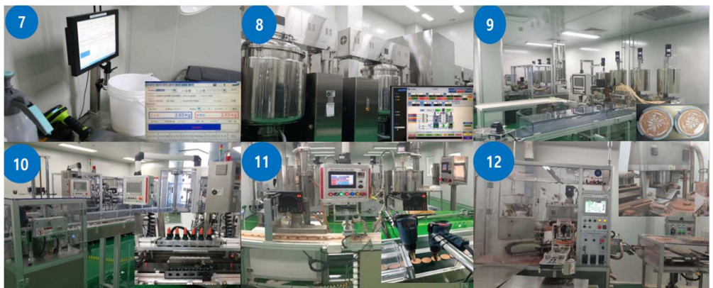
그림3 한국콜마 무석공장 생산설비(2): 원료 계량 바코드 시스템, PLC 탱크 운영 등
