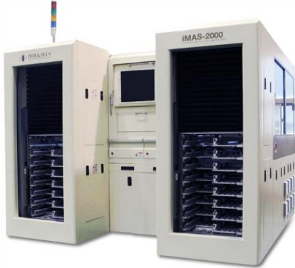
메모리 모듈의 외관 결함 검사 장비. 광 삼각법을 통한 실시간 3D 검사
