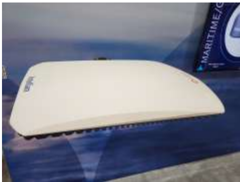
도표 90. 평판(Phase array) 안테나
