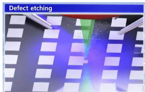
그림92 e-Beam 을 통한 Amplitude defect 제거
