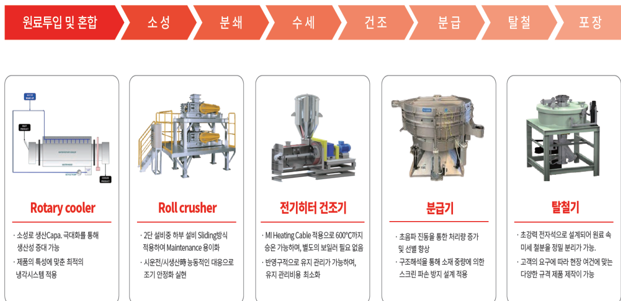
그림 34. 강원에너지 이차전지 양극재 제조공정 설비
