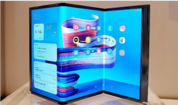
그림5 삼성전자 Flex S 더블폴딩 (인폴딩 + 아웃폴딩)
