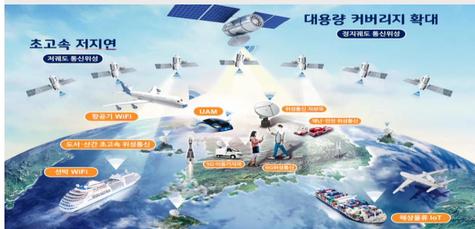
그림4 6G 시대 초공간 서비스를 위한 위성통신망 구조도
