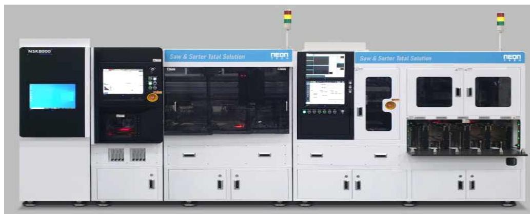
[그림 16] 동사의 블레이드 자동교환 소싱클레이션 장비(NSK-8000)
