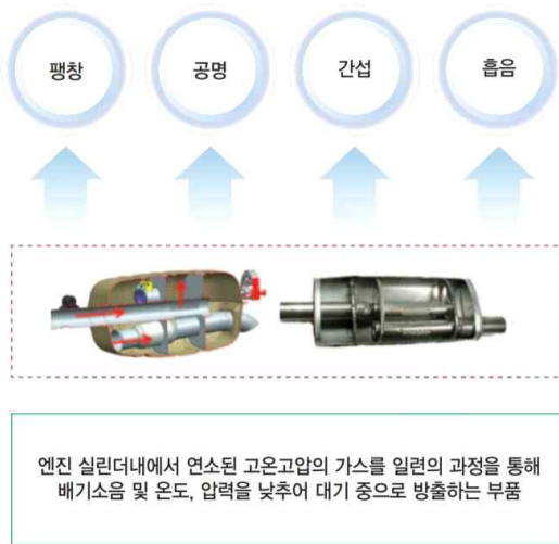
[그림 6] 자동차 머플러(소음기) 기능
