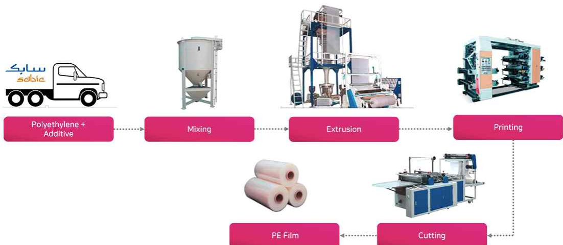
그림 7. 동사의 PE 필름 제조 공정
