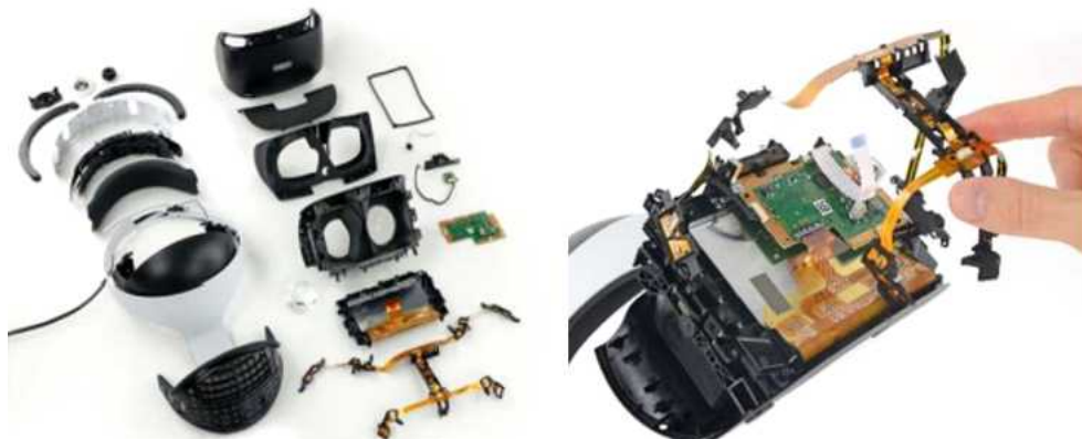
[그림 4] 동사의 VR/AR 기기 적용 FPCB 예시
