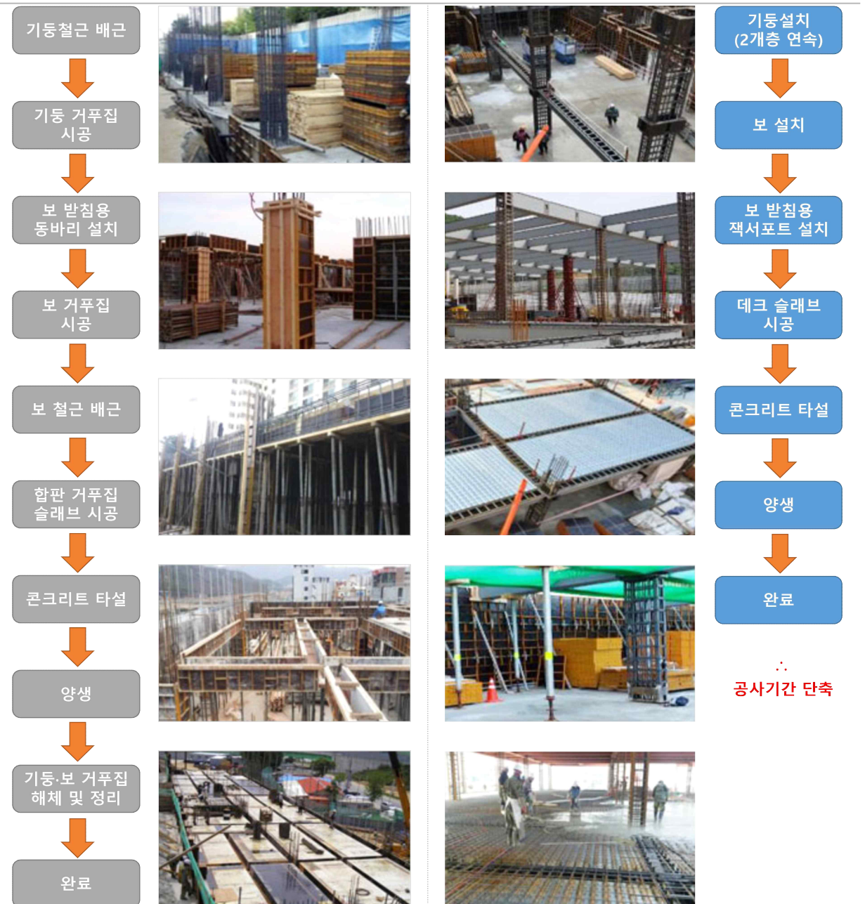
[그림 3] 기존 RC 공법(좌) 및 NRC 공법(우)의 비교
