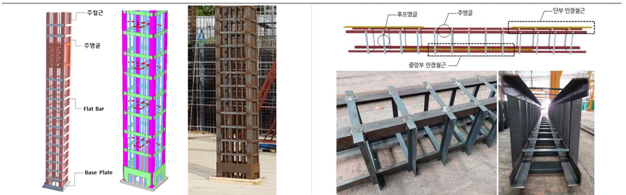
[그림 4] NRC 기둥(좌) 및 NRC 보(우)
