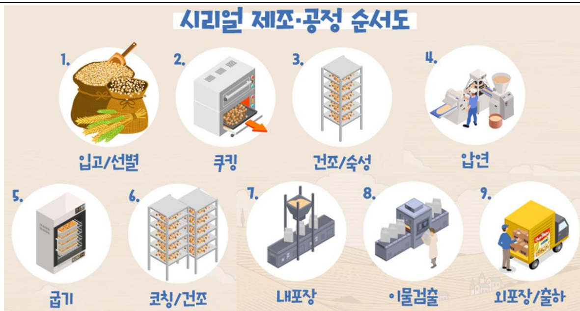
그림 2>> 시리얼 제조·공정 순서도
