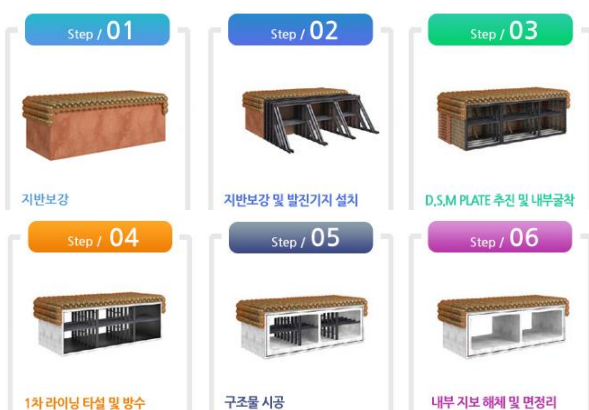
그림8. DSM 공법 시공 순서도
