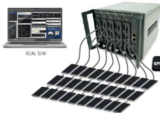
[그림 2] 무선망 품질분석 기술 기반 측정 시스템
