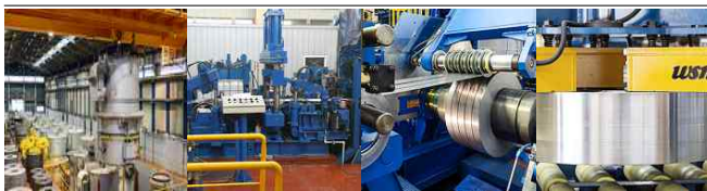
4. 어닐링 공정 5. 조질압연 공정 6. 슬리팅 공정 7. 포장 공정
