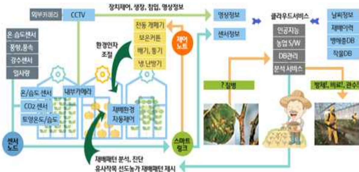
[그림 8] 2세대 모델(2018) : 지상부 복합환경제어 + 클라우드 서비스
