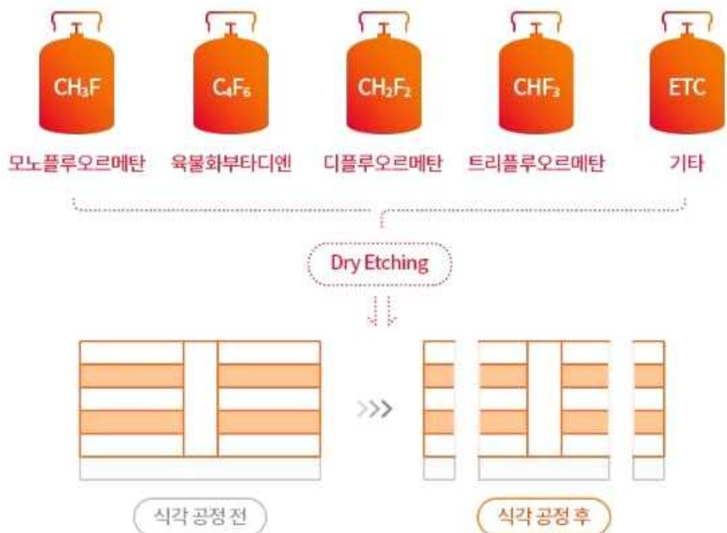
[그림 6] 반도체 에칭용 특수가스의 종류 및 공정 적용
