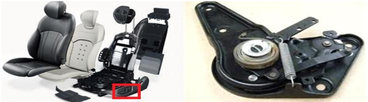
[그림 9] 일반적인 자동차 시트 구조 및 리클 라이너 구조
