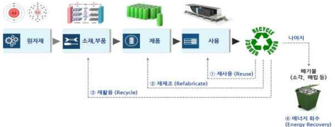
[그림 6] 폐배터리 활용 과정
