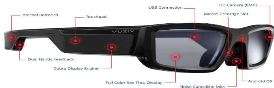
[그림 4] 커넥티드 스마트글라스의 H/W 구성
