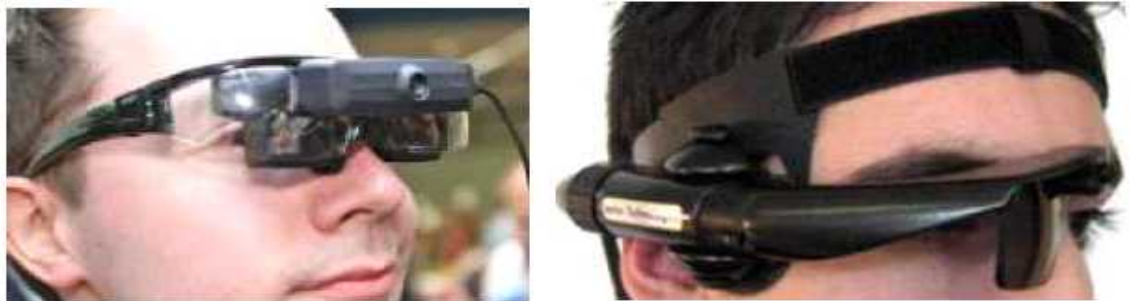
[그림 7] 반사곡면 거울 방식의 커넥티드 스마트글라스(좌: Vuzix사, 우: Laster사)
