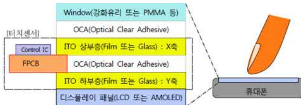
[그림 2] 접촉식 정전용량 방식 터치센서 구조
