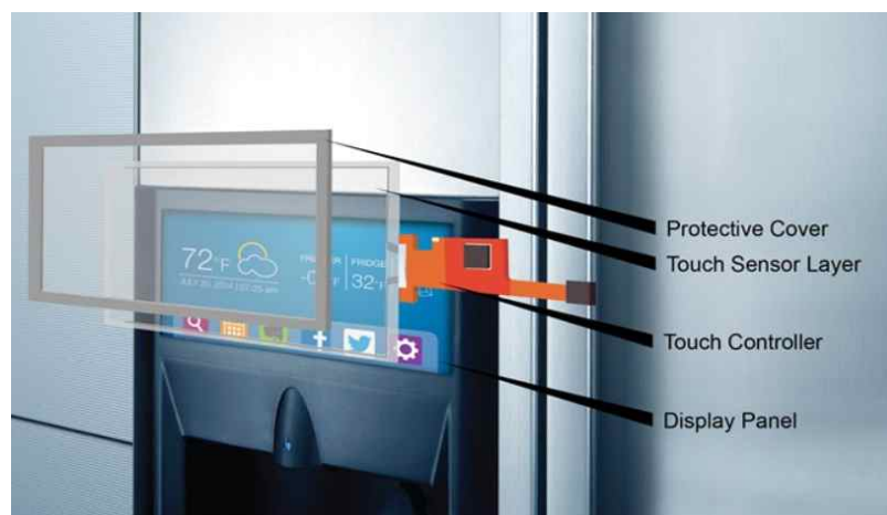
[그림 6] 정전용량 방식 터치패널 구조
