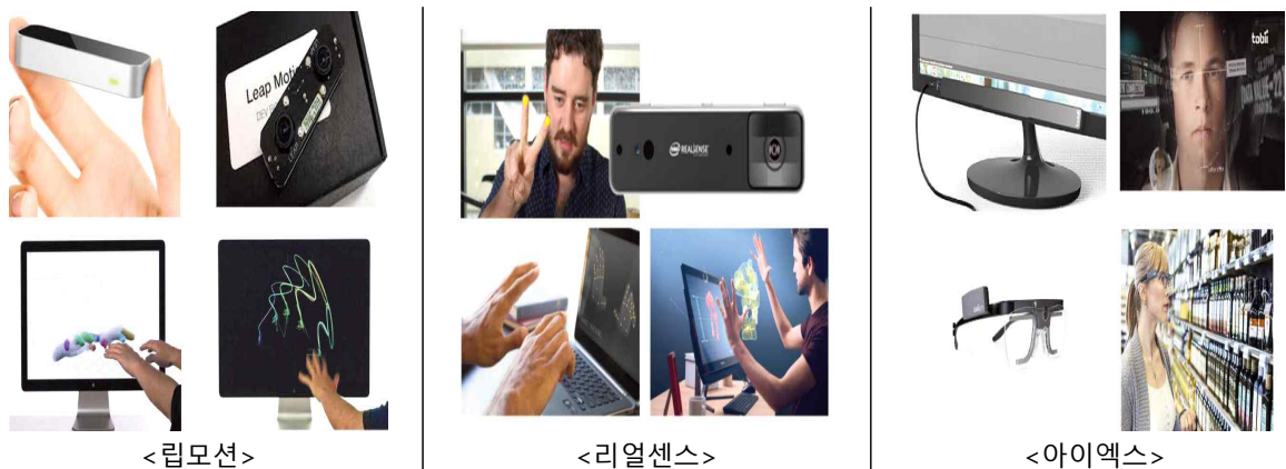
[그림 9] 3차원 터치기술 적용을 위한 비접촉식 센서
