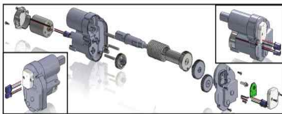
&lt;토크 조절 스프링을 포함한 전동댐퍼 설계도&gt;
