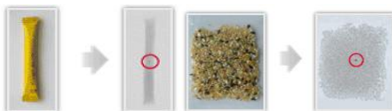
그림 10. 식품 X-ray 검사장비 이물 검출 예시
