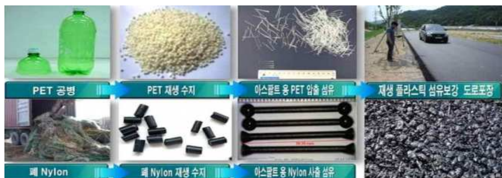
[그림 8] 도로포장용 재료 추출기술(플라스틱 업사이클링 소재기술 관련)
