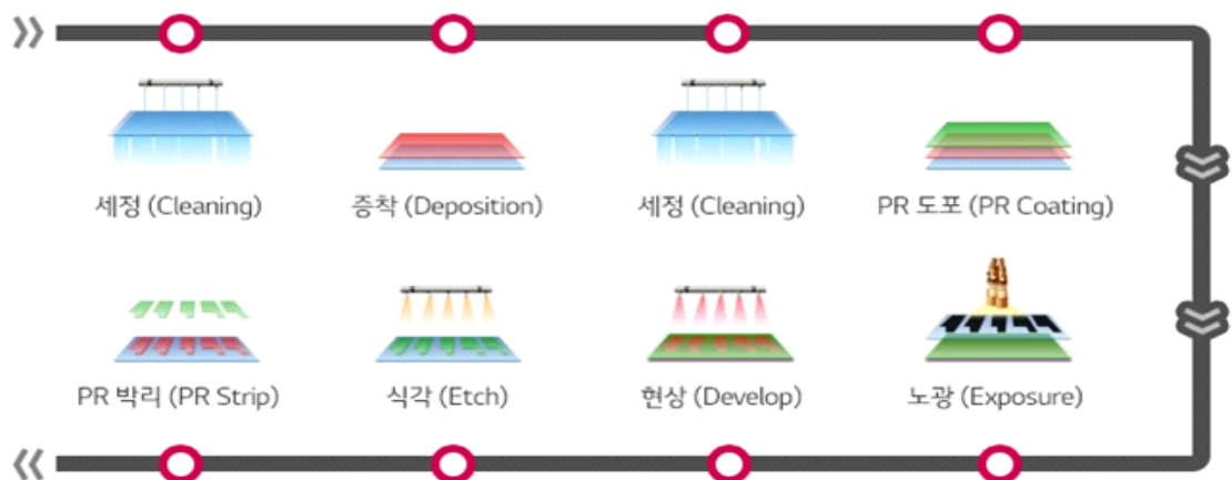
그림 10. 디스플레이 패널 제조 공정도
