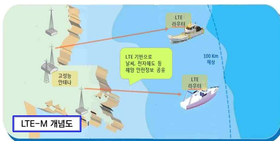
[그림 3] 초고속 해상통신망(LTE-M) 개요도
