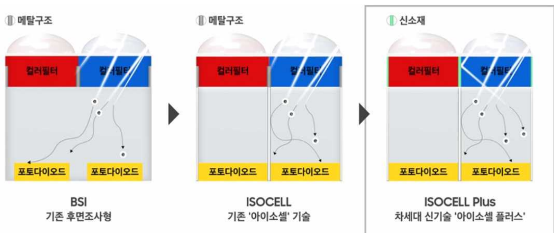
[그림 9] 삼성전자 이미지센서 '아이소셀 플러스' 기술 모식도
