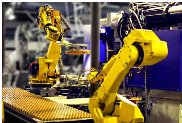
[그림 5] 화낙의 인공지능 기술 기반 빈 피킹(bin picking, 통에서 물건을 고르는 동작) 시연
