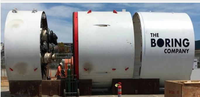
그림4 보링컴퍼니의 TBM(Tunnel boring machine)
