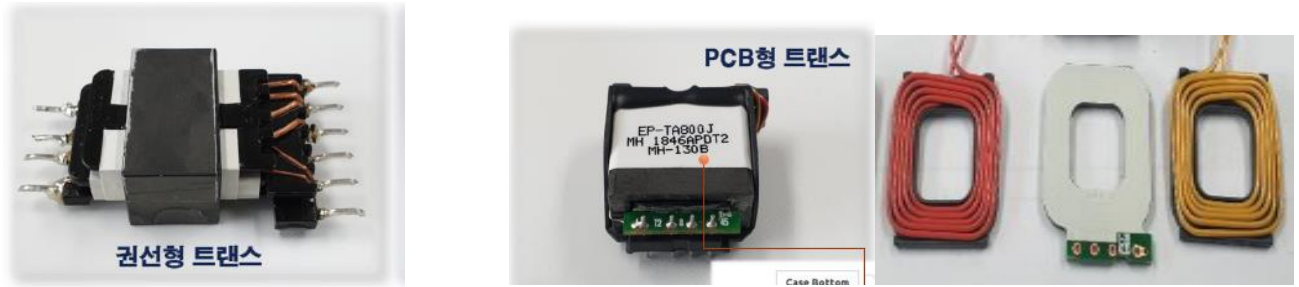
그림 3>> 기존 권선형 트랜스와 동사가 개발한 트랜스 PCB
