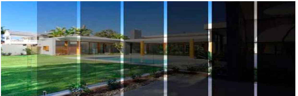
[그림 3] 스마트 유리의 적용 및 제어를 통한 광 투과도 변화
