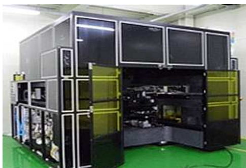
그림 6. 동사 FMM 인장기 및 Mask Frame
