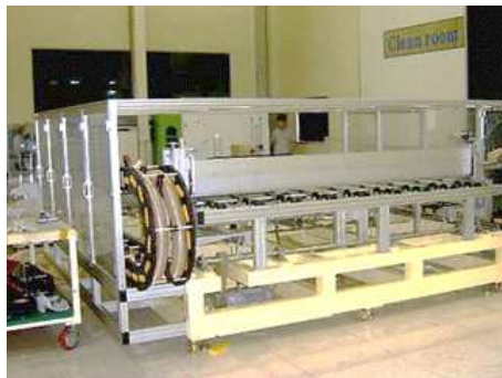
그림 8. 초음파 건식 세정기 및 주요 특허 기술
