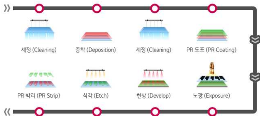
그림 4. 디스플레이 패널 제조 공정도
