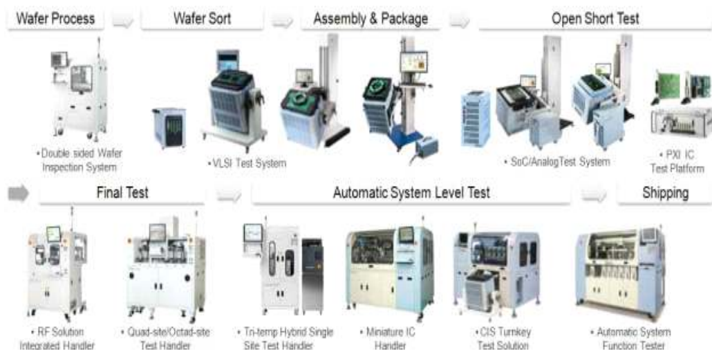
그림 6. 반도체 후공정 및 검사 순서도 및 검사장비
