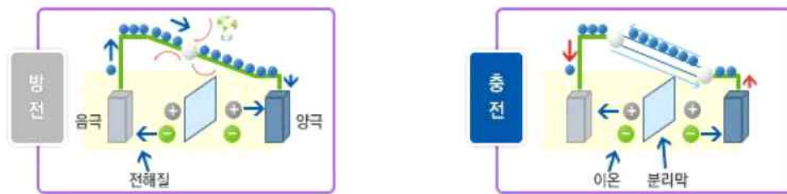
서로 다른 양 음극소재의 전압차이를 이용하여 전기 저장, 발생 (방전) 음극 → 양극으로 전자 이동, [충전] 양극 → 음극으로 전자 이동
