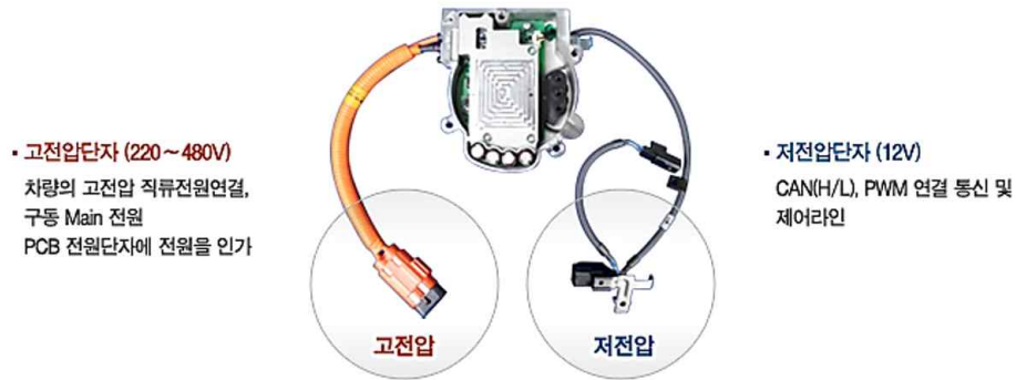
그림 12. 동사 생산 전동 컴프레서용 인버터 구조
