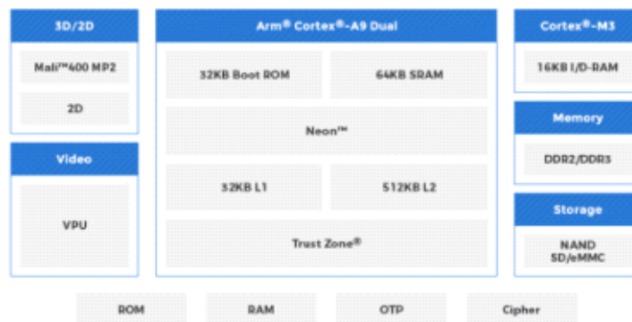
그림 9. TCC893x Car AVN Solution 구성도
