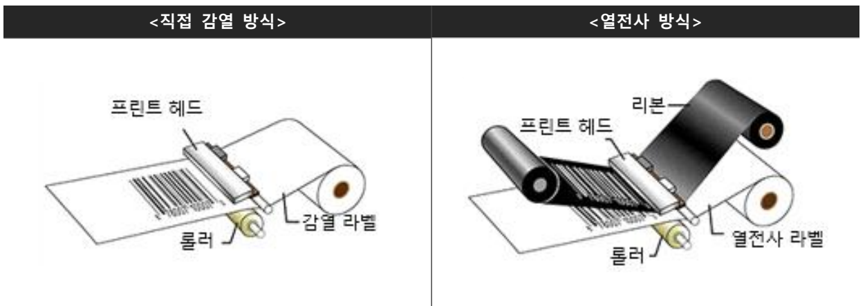
그림 7. 직접 감열 방식과 열전사 방식의 원리
