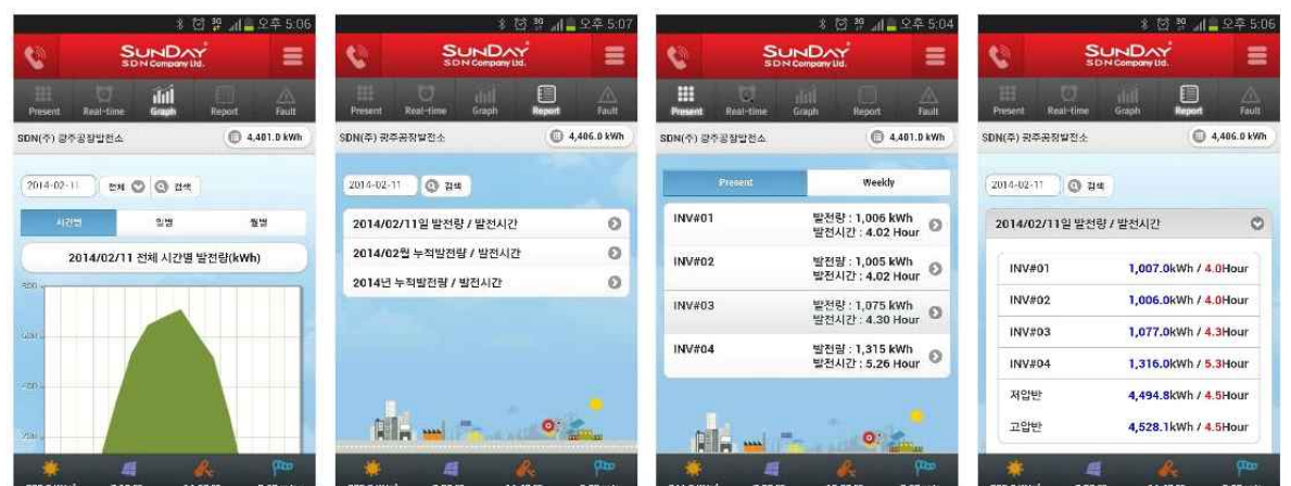
그림 11. 애플리케이션을 활용한 스마트 태양광 모니터링시스템
