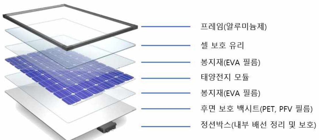
그림 8. 태양전지의 모듈의 내부 구조
