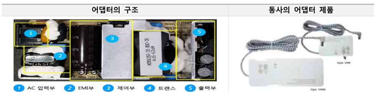
[그림 7] 어댑터 구조 및 제품
