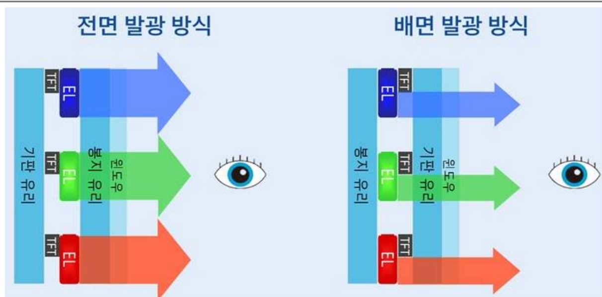
[그림 4] OLED 디스플레이의 발광 방식에 따른 분류
