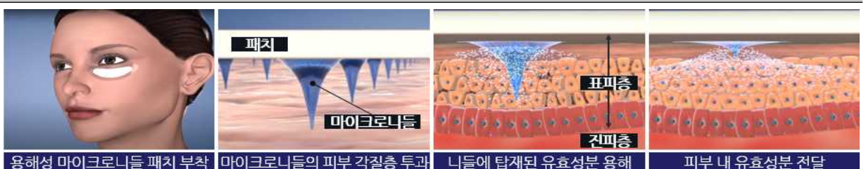
[그림 12] 용해성 마이크로니들 패치의 유효성분 전달 원리
