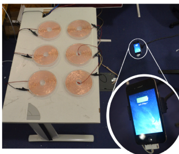
[그림 3] MagMIMO를 이용한 전력전송 방식 시제품
